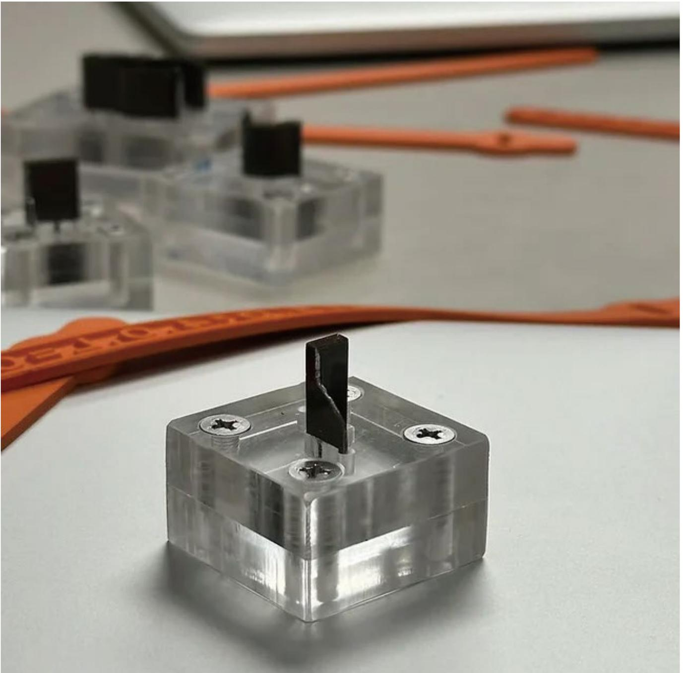
データー印というゴム印の窓抜きに使用されている刃
